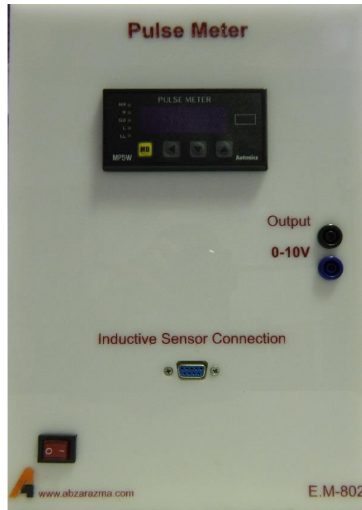
شکل ۶-۱ ماژول دورسنج با ورودی سنسور القایی و خروجی ۰-۱۰ ولت آنالوگ
