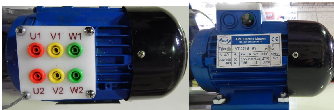
شکل ۱-۱ موتور القایی سه فاز ۵۵۰ وات از نمای بالا و کنار
