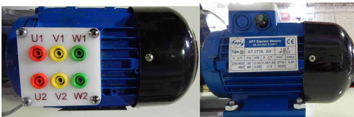
شکل ۱-۴ موتور القایی سه فاز ۵۵۰ وات از نمای بالا و کنار
