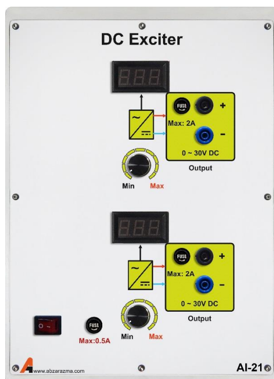
شکل ۲-۷ مازول تغذیه برای ایجاد ترمز مغناطیسی
