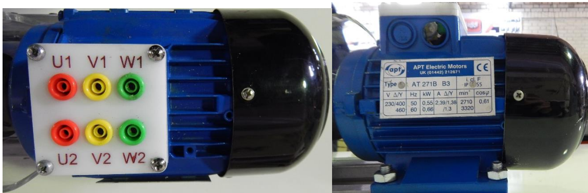
شکل ۱-۲ موتور القایی سه فاز ۵۵۰ وات از نمای بالا و کنار
