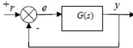
شکل ۲-۶ بلوک دیاگرام کنترل فیدبک واحد
