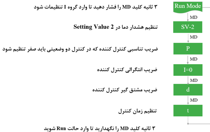
شکل ۱-۶ تنظیم کنترل کننده برای کنترل تناسبی - مشتقی
