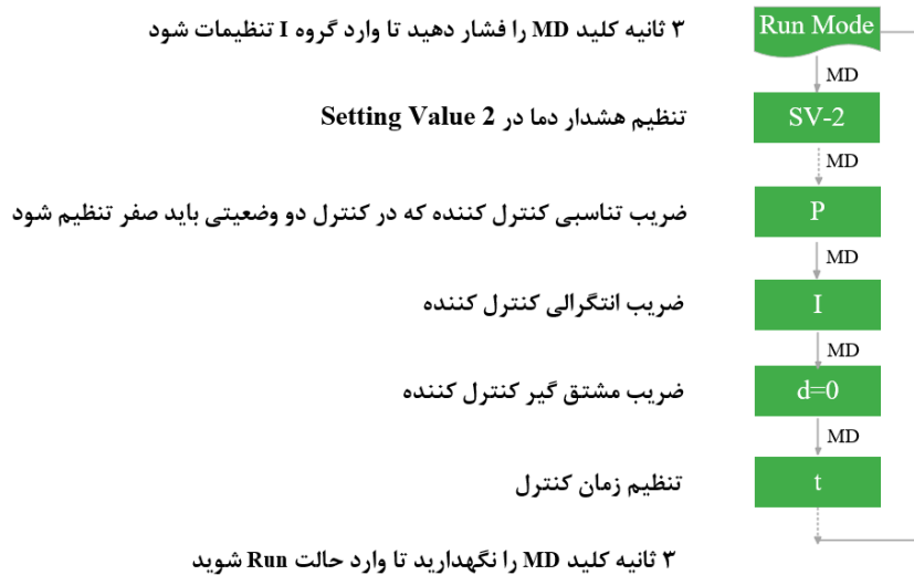
شکل ۱-۵ تنظیم کنترل کننده برای کنترل تناسبی - انتگرالی
