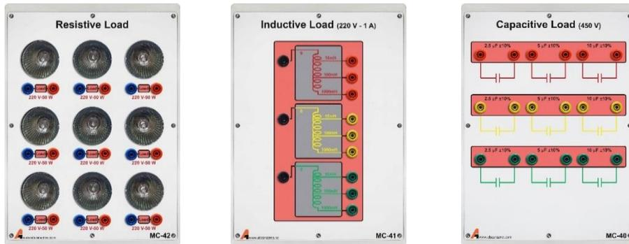
شکل ۱-۱ بارهای الکتریکی مورد استفاده در آزمایش‌ها
